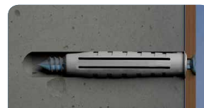
6. A bucha está instalada
