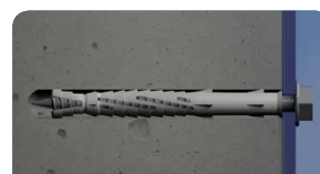
6. A bucha está instalada
