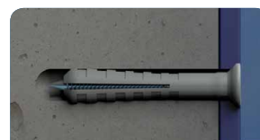
6. A bucha está instalada
