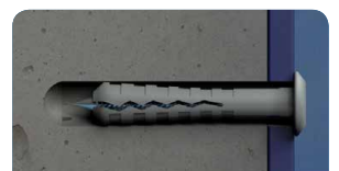
6. A bucha está instalada
