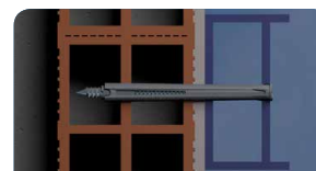
6. A bucha está instalada
