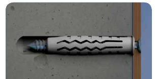
6. A bucha está instalada
