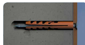
6. A bucha está instalada
